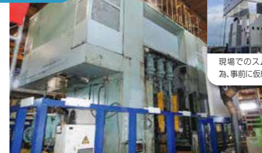
104dB プレス機の騒音により、会話が不可能な作業エリアでした。
